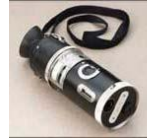
Resim 1.1:Lambalı pirometre
